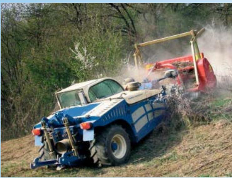
Trasmissione idrostatica a variazione continua con controllo automatico della coppia. 4 ruote motrici e sterzanti isodiametriche. Ponti differenziali heavy duty con bloccaggio differenziale 100% su entrambi i ponti ad innesto eletro-idraulico.
