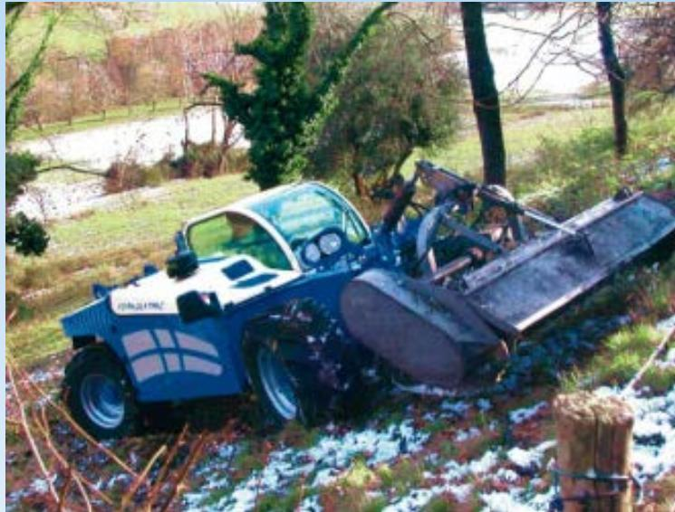
Il sollevatore anteriore può essere dotato del sistema **AGC** (Automatic Ground Contour) con barra porta ganci pivotante: la rotazione idraulica dei ganci con posizione flottante permette di svincolare il movimento dell'attrezzatura frontale dall'assetto della trattore consentendone un perfetto e costante livellamento al terreno. Il controllo dell'inclinazione dell'attrezzo agevola notevolmente le lavorazioni su forti pendenze trasversali.
