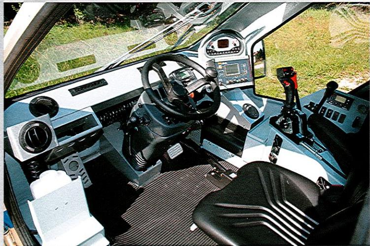
» Cabina confortevole, pressurizzata. Sistema di filtrazione per prodotti fitosanitari e polveri. Cabina di categoria 4.
